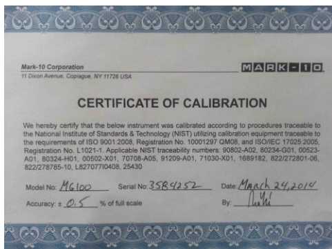
Foto 7: Certificat de calibratge pertinent del manòmetre
