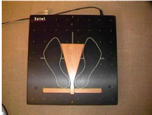
Imagen 2: plataforma de estabilometría para análisis estático
