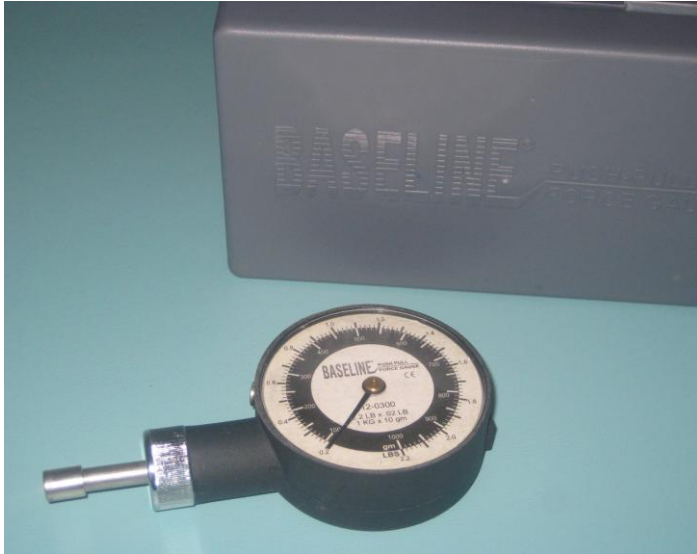
Fotografia 1. Algòmetre utilitzat per la mesura de Punts de Chapman.
